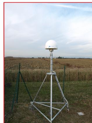
**Figura 6.** Schema di monumentazione secondo le tecniche importate dall'Ohio State University con misure d'ingombro e una foto di una stazione realizzata con questa metodologia.
